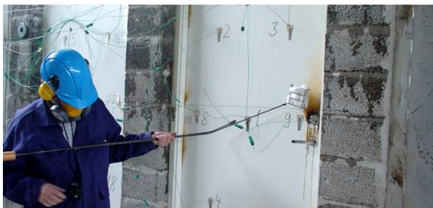
Figura 4.4 Testarea etanșeității la foc a elementelor de construcții ( www.egolf.org.uk , 2013)
